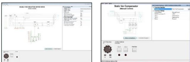
Les fonctions de commande de micrologiciel mises en œuvre à l'aide du DACI, via le logiciel gratuit LVDAC-EMS, permettent de mettre en œuvre des dispositifs complexes, tels qu'un SVC et un HVDC, directement dans le laboratoire. Les fonctions micrologicielles peuvent être achetées individuellement ou par paquets.
